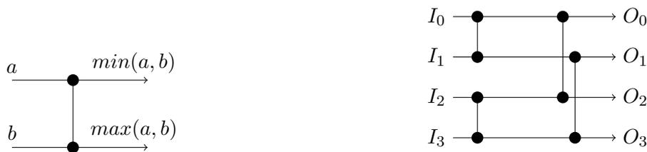
FIGURE 1 – Un comparateur et un réseau de comparateurs.
