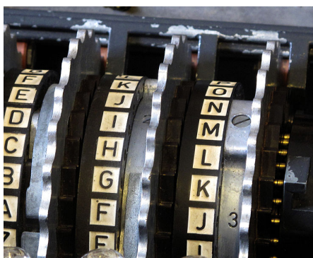
FIGURE 3 – Les rotors : groupe de trois rotors installés dans la machine (à gauche) ; interface électrique entre deux rotors (à droite).
