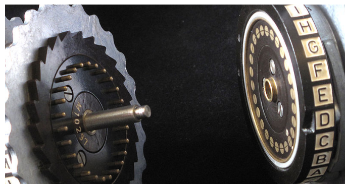
FIGURE 3 – Les rotors : groupe de trois rotors installés dans la machine (à gauche) ; interface électrique entre deux rotors (à droite).
